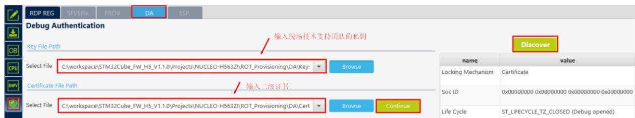
如上图所示, 在 STM32CubeProgrammer 中, 在 ST-Link 断开的情况下, 点击 Discovery 按键, 然后在 key File path 处输入现场技术支持团队自己的私钥:
