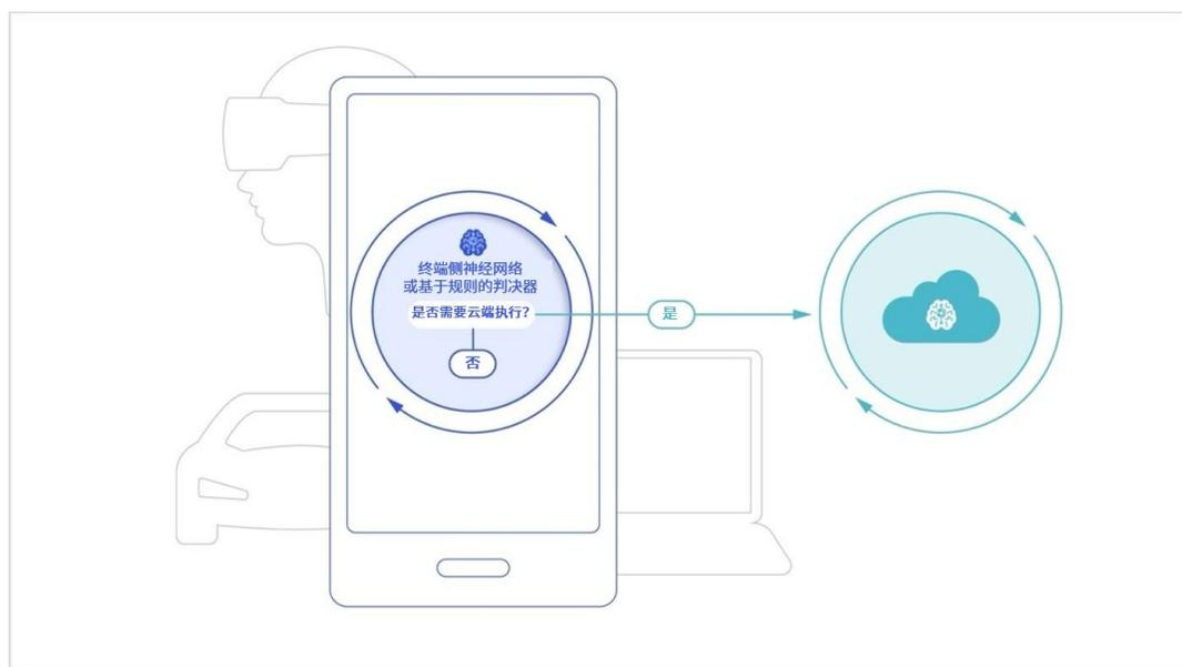
图2：在以终端为中心的混合 AI 架构中，云端仅用于分流处理终端无法充分执行的 AI 任务。
