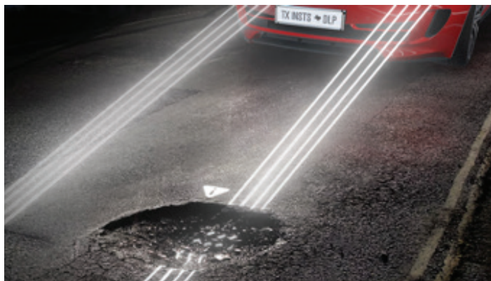
图 6.DLP 前照灯与 ADAS 摄像头系统配合工作,可检测到道路上的物体并向驾驶员发出警告。
