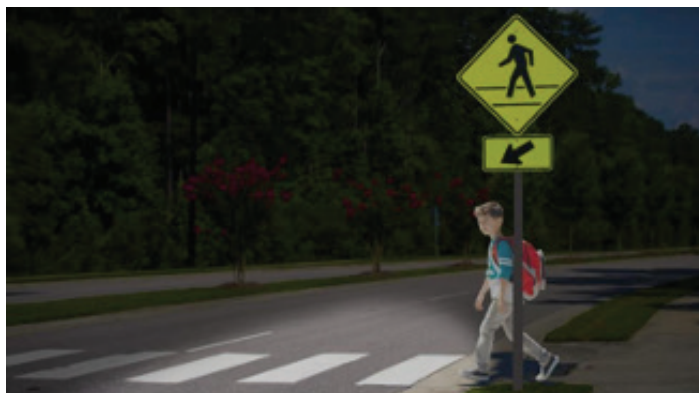
图 7.DLP 前照灯醒目地照亮了一个试图横穿马路的儿童,同时使人行横道标志变暗以减少眩光。
