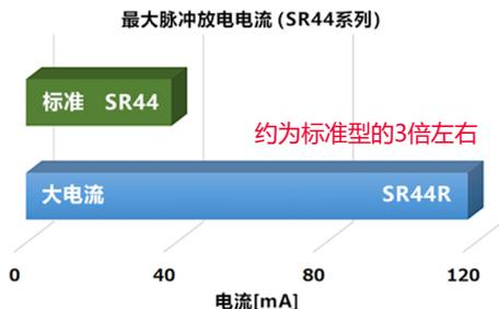
在放电功率方面，和常规的标准型纽扣电池相比，大电流型可以放出更大的电流，最大脉冲放电电流约为以往的3倍（输出电流条件：在23°C的环境下，可确保电压不低于1.2V的电流在DOD 0%、100ms (23°C) 的条件下可维持1.2V以上的电压的最大脉冲放电电流），可以更从容的面对例如动态血糖仪和胰岛素泵中无线模块或者电机的瞬时功率需求。
