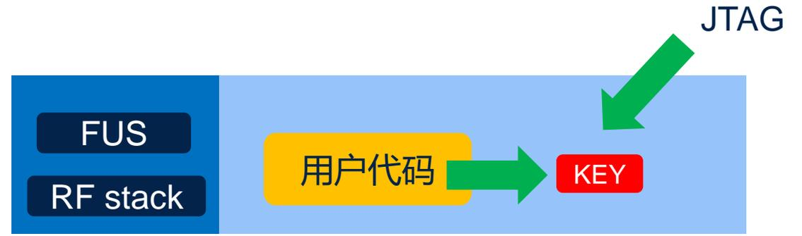
常规方式，密钥直接存储在user flash上
