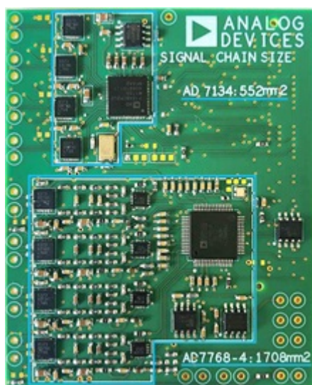
图 15. 离散时间信号链和连续时间信号链尺寸比较
