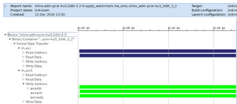
图 44: “Device Hardware Transaction”视图 DDR bank 上的传输事务
