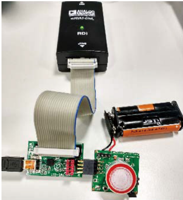
图9. 将编程/调试POD连接到EVAL-ADuCM355EMCZ
