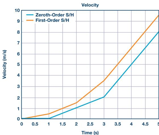
图7. 速度计算中的零阶保持与一阶积分方法比较。
