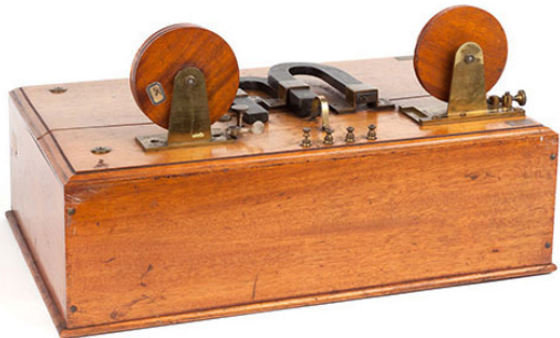
图9. 像马可尼那样使用的磁检波器。 3
