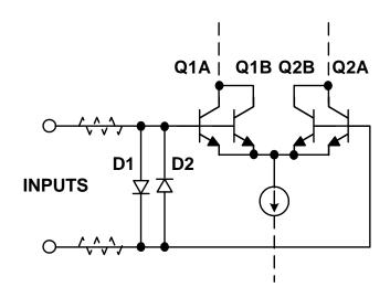
图4: 具有D1-D2输入差分过压保护网络的运算放大器输入级
