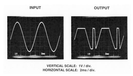
图1: 电压跟随器的输出电压相位反转
