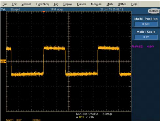
图9. EVAL-CN0373-EB1Z板上RS-485端口的Y-Z数学波形
