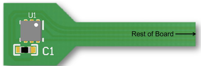
图 1. TMP117 (U1) 位于柔性 PCB 上。使用延伸臂可将集成电路与其他器件产生的热量隔开。
